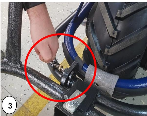
**Abb. 3** Das Aufladen von Last ist wie folgt: Die Verriegelung des Schlosses des Universalträgers entfernen und die Gabel auf den Boden absenken.
